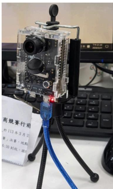
AMB82 mini開發板：可以連接LED、開關、壓力計、濕度計、PM2.5粉塵傳感器等電子元器件。收集到的數據可以通過WiFi上傳，提供應用程式使用，實現物聯網應用。
